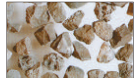
KA bzw. ..Z = Zirkonkorund sehr hohe mechanische Festigkeit
